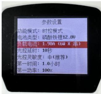
负载电流 0.33A-10.5A, 0.33A 一个档位, 负载功率按照设置的电流×所接对应的光源电压
